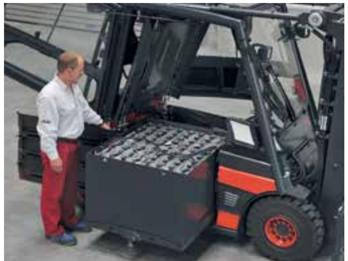
Боковая замена батареи на всех электропогрузчиках Linde позволяет избежать использование крана. Замену можно производить другим погрузчиком, гидравлической тележкой или иными специализированными устройствами.
