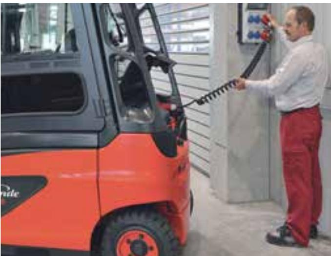
Встроенное зарядное устройство с функцией автоматической вытяжки позволяет заряжать аккумулятор, не извлекая его из погрузчика и не открывая капот, окна и двери кабины.
