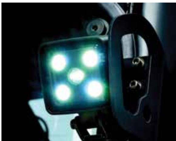
Сверхяркие, но энергосберегающие и виброзащищенные **светодиодные рабочие прожекторы** вносят важный вклад в безопасность эксплуатации погрузчиков.
