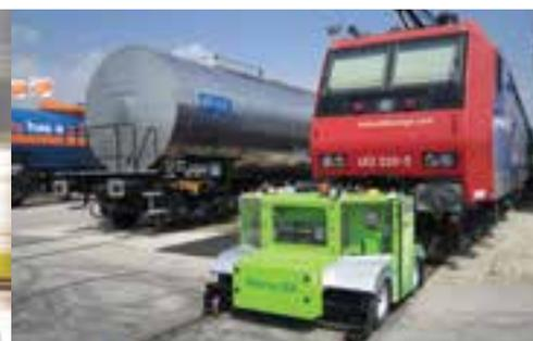
Rotrac E2 — компактная дрезина на электротяге, способная перемещать тяжелейшие железнодорожные составы. В основе конструкции — электропривод от Linde.
