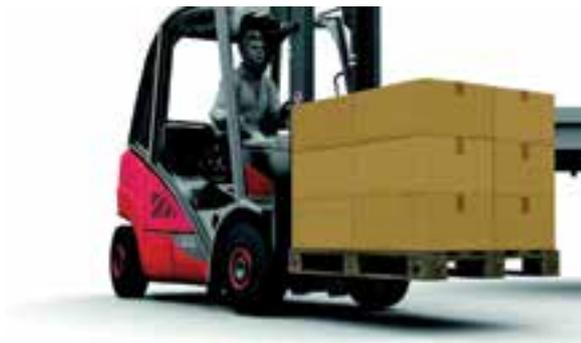
Linde — первый производитель погрузчиков в мире, включивший функцию обеспечения безопасности в поворотах **Curve Assist** в стандартную комплектацию погрузчиков с ДВС (на моделях H20–H50). При прохождении поворотов система автоматически удерживает скорость движения погрузчика на безопасном уровне, что позволяет использовать машину на пределе эффективности без угрозы превышения этого предела.
