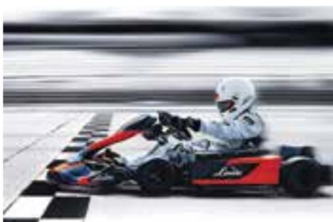
Электрокарт Linde E1, созданный на основе электромотора и контроллера от погрузчиков Linde E20 - E50, установил мировой рекорд скорости, разогнавшись до 100 км/ч за 3,45 с.
